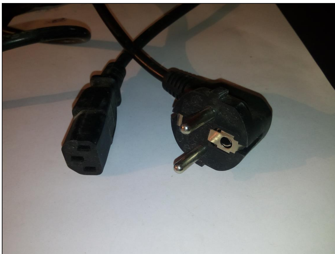
Εικόνα 6: Ρευματολήπτης – Φις Τύπου F (μόνο για ρευματοδότη τύπου 'schuko')
